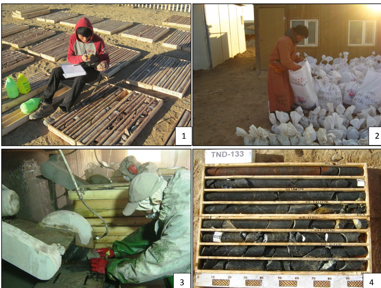
Фото зураг 2. 1-чөмгөн дээжийн соронзон чанарын хэмжилт, 2-шинжилгээнд явуулах багцыг шалгаж бэлтгэж байгаа байдал, 3-чөмгөн дээжийг таллан хуваах зүсэх ажиллагаа, 4- чөмгөн дээжийг хайрцаглаж холбогдох гүн, дугаар тавьсан байдал
